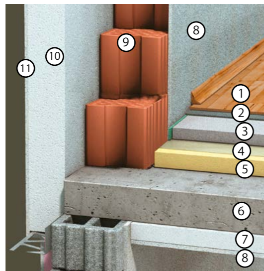
Abb. 18 | Dämmung der Kellerdecke
