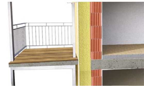
Abb. 25 | Vorgestellter Balkon – keine Wärmebrücke
